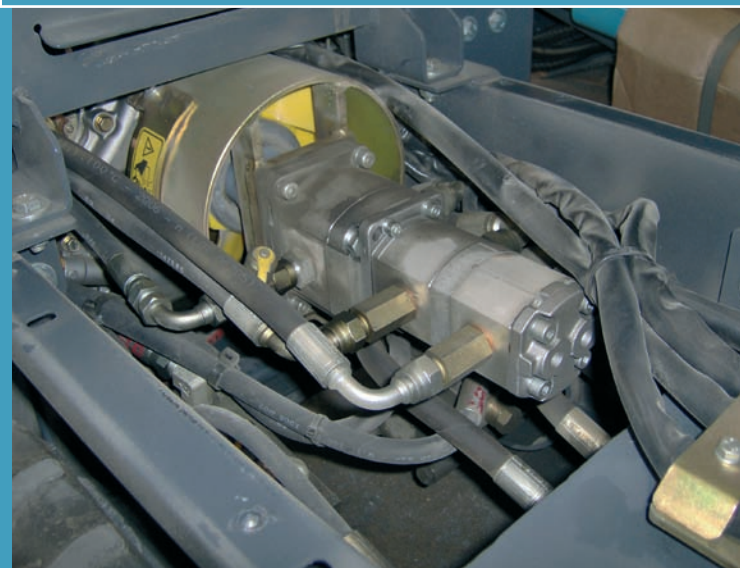
Detail of the Hydraulic oil cooling system (Patented) Detail Kühlsystem Hydrauliköl (Patentiert) Деталь (часть) системы охлаждения гидромасла (запатентовано)
